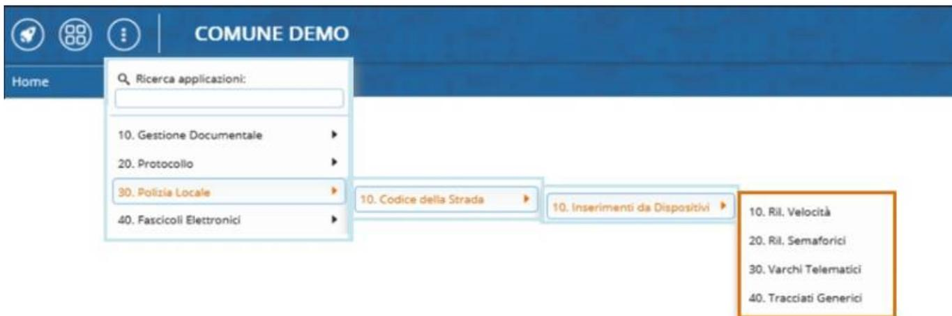
Le sotto-sezioni di "Inserimento da Dispositivi" si differenziano per la tipologia della fonte dei dati ( *semafori* e *varchi*, dove andrà creato il servizio e caricato il contenuto, da *autovelox* o da *altre tipologie*).
