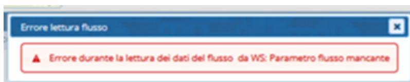
significa che nell'archivio dei provvisori di tesoreria non è stato valorizzato il campo "id flusso", questo si verifica nel caso in cui il giornale di cassa (che contiene i provvisori di tesoreria) è stato importato da cityware client/server. Per risolvere la problematica, è sufficiente lanciare una utility di
