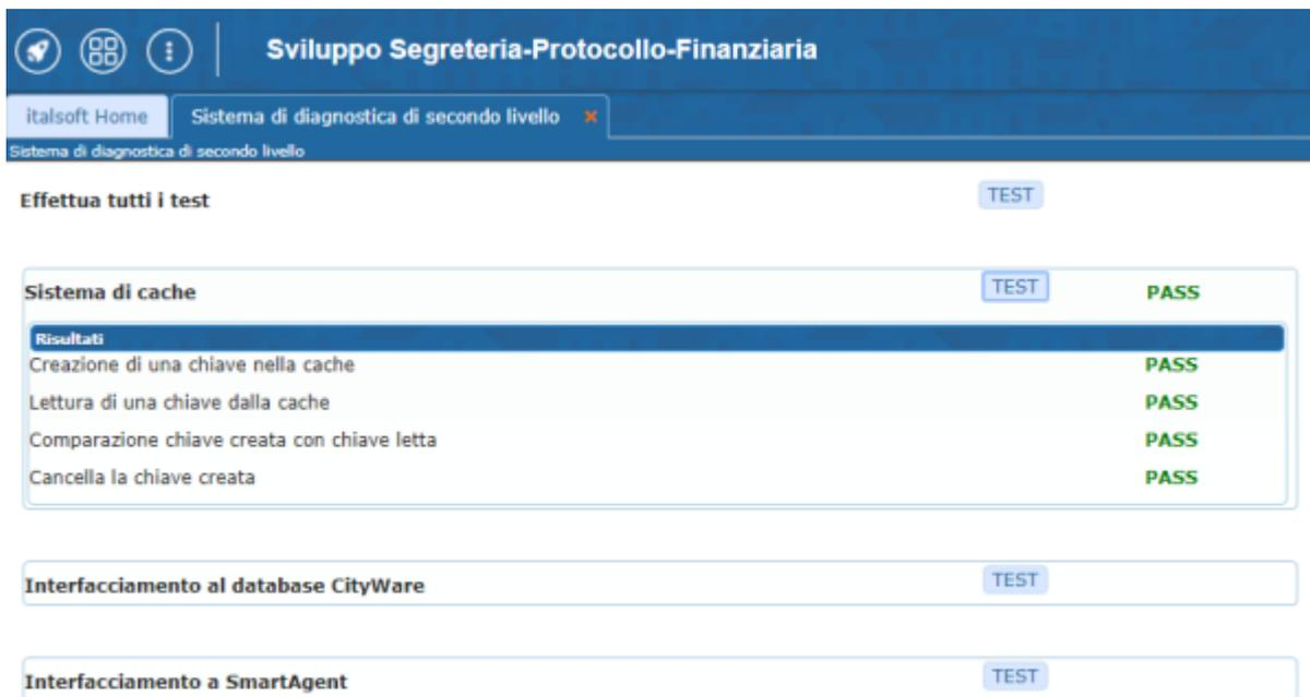
In questo caso, la classe estende semplicemente **itaFrontController** in quanto non deve lavorare con il database, ma lanciare dei test per una diagnostica di secondo livello. Anche a livello di generator la struttura della pagina sarà molto diversa da una pagina CRUD tradizionale. L'unico punto in comune con le CRUD può essere quindi solamente il **parseEvent**.
